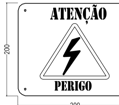
6 PLACA DE ADVERTÊNCIA NA PORTA DO QCM (NR10)
