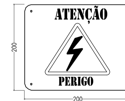
3 PLACA DE ADVERTÊNCIA NA PORTA DO QDFL (NR10)
